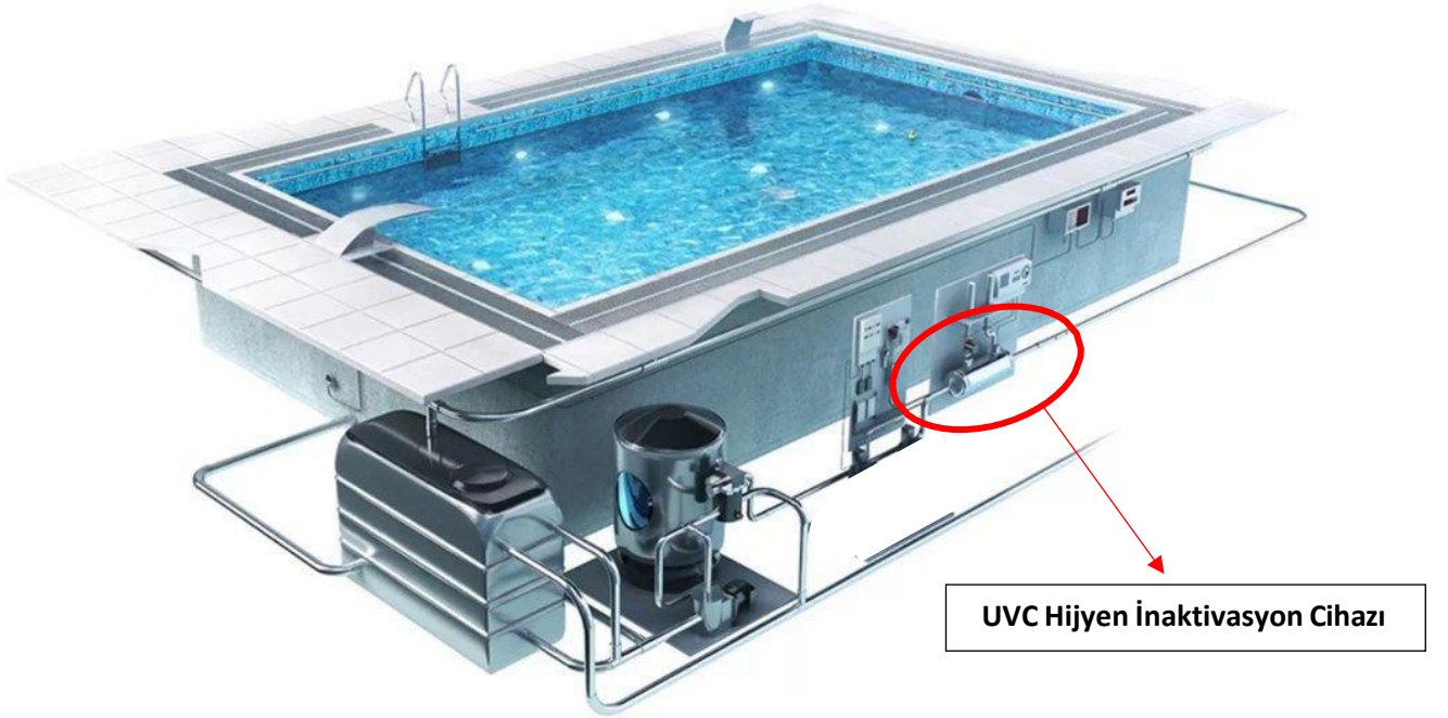
Şekil 6. UVC Hijyen İnaktivasyon Cihazının devir daim sistemindeki konumu
